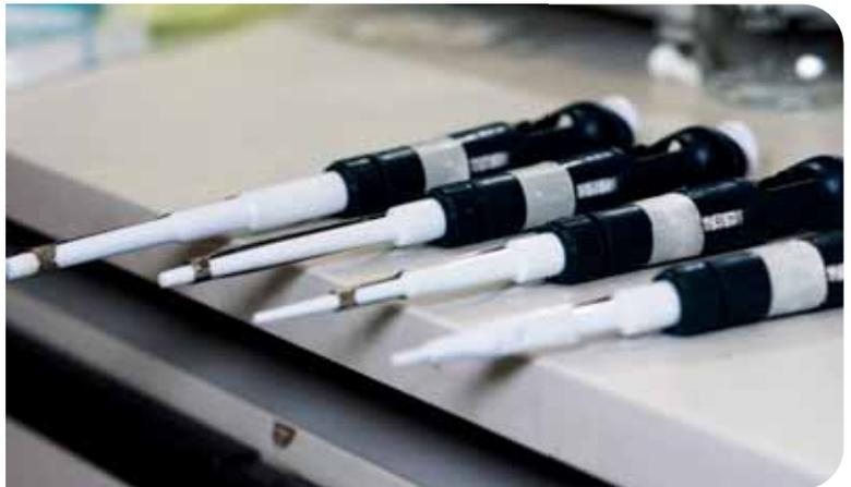
**„In einem Biochemie-Labor gibt es eigentlich nichts, was ohne Pipette zu erledigen wäre“, sagt die Biochemikerin Andrea Pichler. Mit dem Werkzeug lassen sich Flüssigkeiten mit einer Abweichung von wenigen Mikrolitern aufnehmen und in kleine Teströhrchen pipettieren; das tut Andrea Pichler Hunderte Male pro Tag.**
